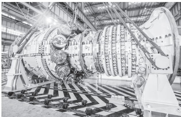
>> 2024年10月7日，我国自主研制的300兆瓦级F级重型燃气轮机在上海临港首次点火成功 新华社/发
