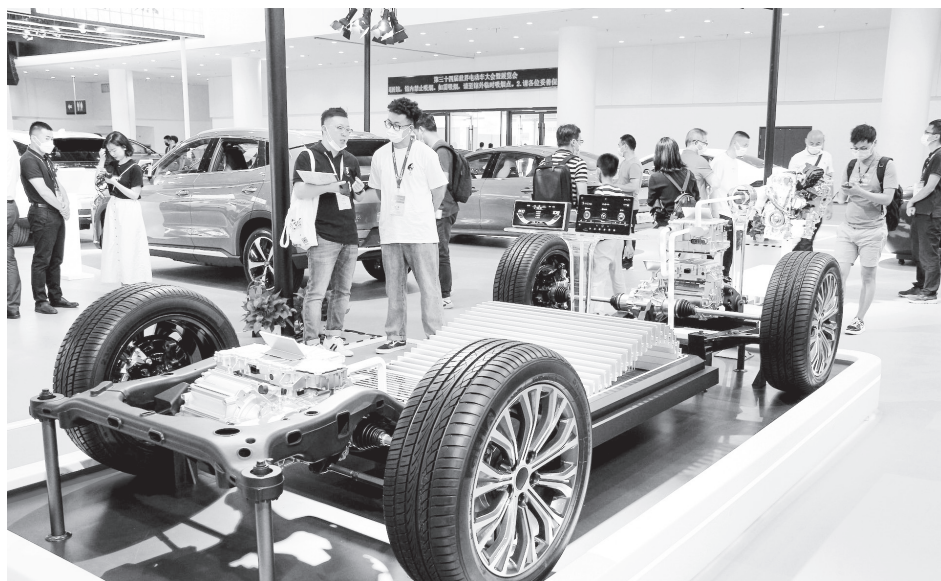
>> 动力电池被誉为电动新能源汽车的心脏，在船舶、工程机械、低空经济等领域应用广泛。图为在南京举行的第34届世界电动车大会上，中国车企比亚迪展示的刀片电池组。
