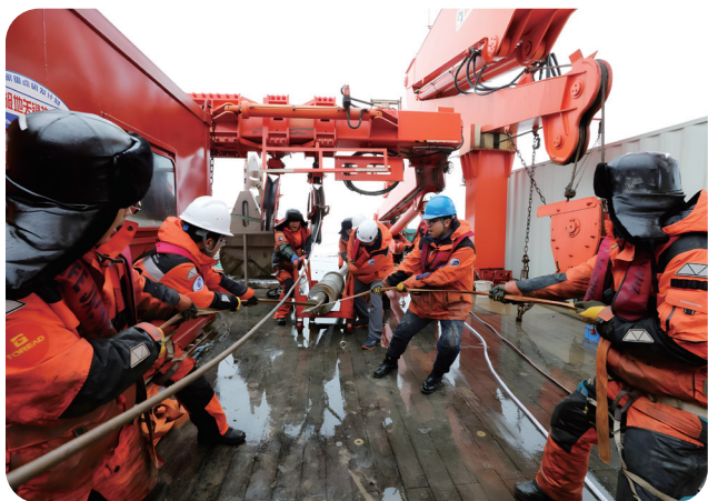
▲8月1日,考察队员在“雪龙2”号上进行重力柱取样作业 刘诗平/摄
